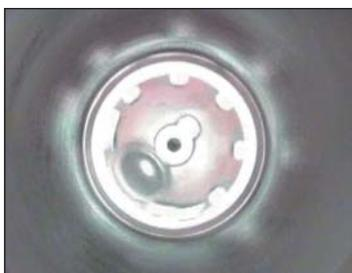
Толстое кольцо конденсата создает высокую сопротивляемость теплопередаче.
